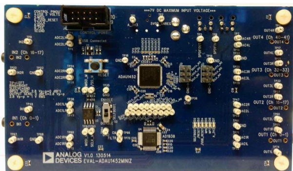
Рисунок 18. Отладочная плата EVAL-ADAU1452MINIZ.
